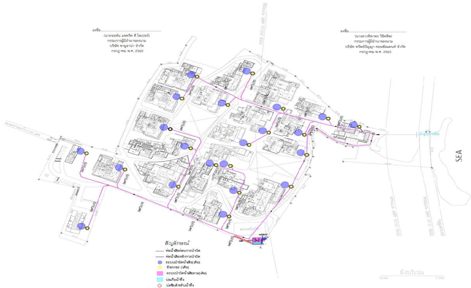
รูปที่ 3.1-2 ผังระบบน้ำเสียของโครงการ ที่มา : บริษัท กรีน เอ็นไว เอ็นจิเนียริง จำกัด, 2568
